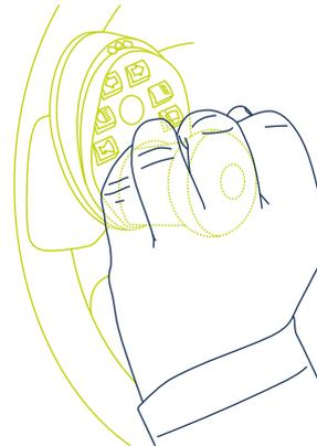
Über die sieben Tasten auf dem Bedienfeld des Multifunktionsdrehknopfs COMDIS können bis zu 12 Steuerungsfunktionen betätigt werden:
